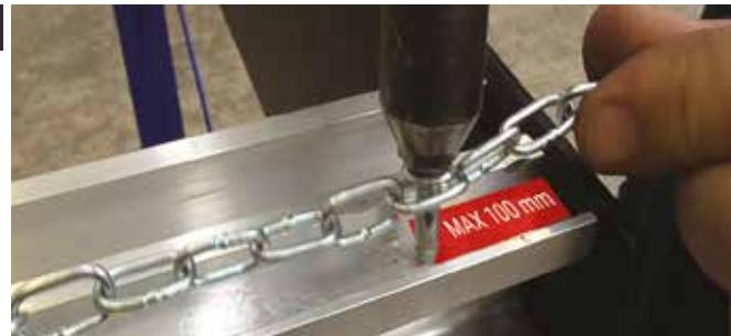
Fissare una delle estremità nastrate in verde rivettando una maglia della catenella in prossimità dell'estremità anteriore della trave.
