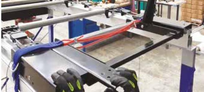
Montare la traversa posteriore.
