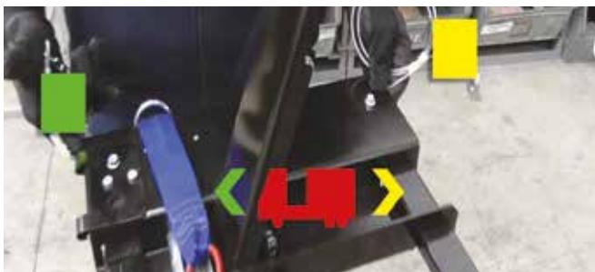
Infilare il carrello avendo cura di mantenere le estremità SCS nastrate in giallo verso il lato porta ed in verde verso il lato cabina. Verificare che il numero di archi sia adeguato al tetto.
