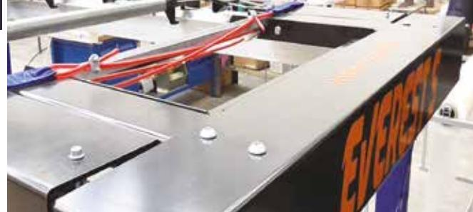
Portare il carrello nella posizione di riposo con traversa abbassata e perni di sblocco ingaggiati nelle sedi di fissaggio. Verificare che la traversa sia perpendicolare alle travi.
