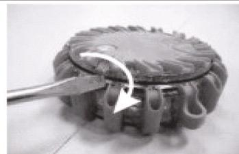
Ruotare delicatamente il cacciavite per sollevare il coperchio, facendo attenzione a non danneggiare l'anello in gomma altrimenti la tenuta stagna del lampeggiante potrebbe esserne compromessa.
