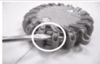
Rigirare il lampeggiante e sollevare la linguetta in plastica con il cacciavite.
