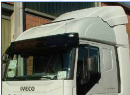
Coppia bandelle laterali realizzati in fibra di vetro colore bianco Kit side parts, fibre glass, white
